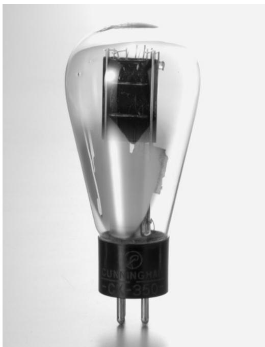
写真1 真空管の有名製造メーカRCAの前進「カニングハム」が何十年もの昔に大出力用として世に送り出した直熱三極管CX-350
