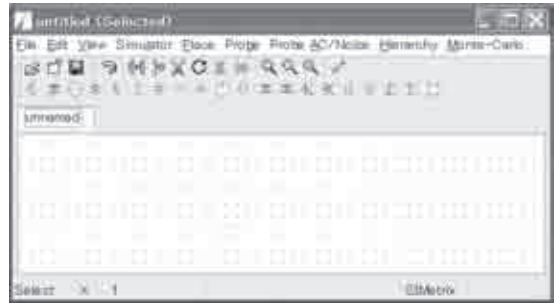
〈図3〉 回路図ウィンドウ Command Shell → File → New Schematic, または Command Shellの白紙のアイコンをクリック
