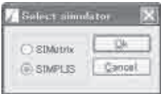
〈図4〉 シミュレータ・セレクト クタ 回路図ウィンドウ・メニュー で File → Select simulator
