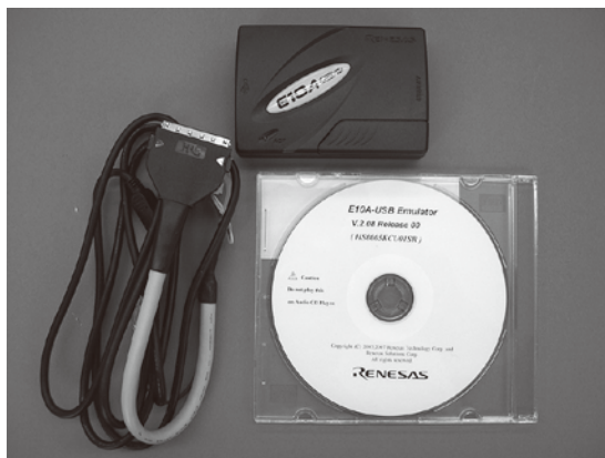
写真 3.1 USB エミュレータ E10A-USB (ルネサス エレクトロニクス社)
