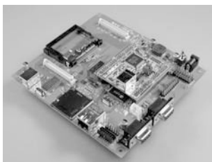
写真1 拡張ベースボードCQBB にV850 マイコン基板を 乗せたところ
