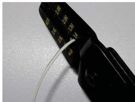
図18 コンタクトに線材を圧着する
