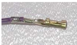
図18 コンタクトに線材を圧着する
