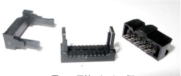
図11 圧接ソケットの例
