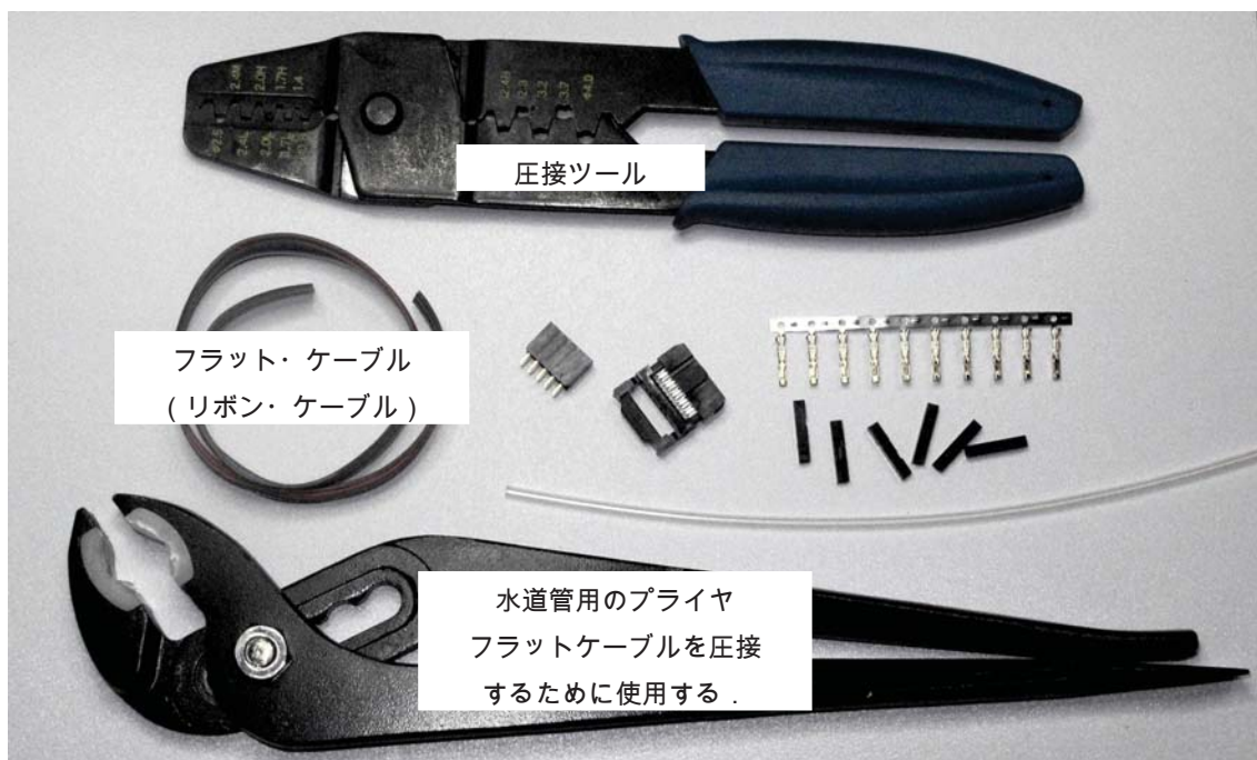
図7 ケーブル作成に必要な工具と部材
