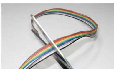
図8 フラットケーブルの切断
