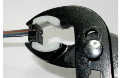
図14 ケーブルを圧接する
