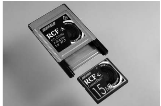
写真2 CFカード(Type I)用のPCMCIAアダプタ
