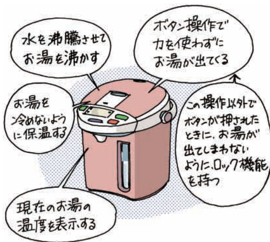
図1 電動給湯ポットの機能 五つの機能を考える
