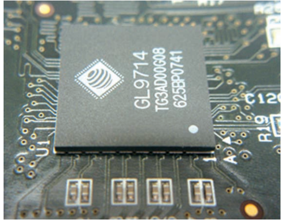
写真 B 2.5 Gbps シリアル信号を 125 MHz/250 MHz パラレル信号に 変換する PHY チップの例
