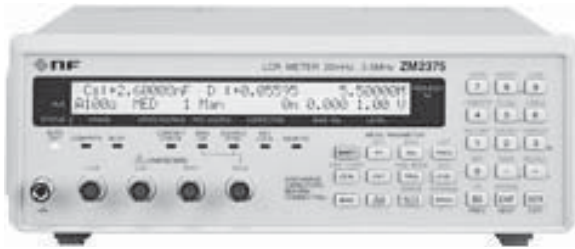
【写真8-1】 実験・試作用高速・高精度LCRメータの一例(エヌエフ回路設計ブロック(株)ZM2375) 分解能6桁で、基本確度0.08%となっている。やや高価だが、パソコン・インターフェースも持っているので幅広く利用することができる
