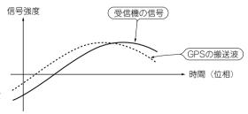
図 4-1 受信機の内部信号と GPS の搬送波との位相を比較する
