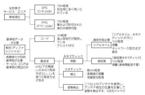
図 4-2 GPS による測位には単独測位と相対測位がある
