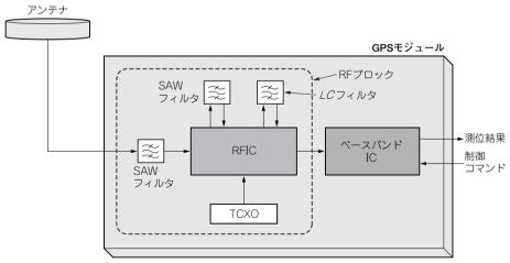
図2-1 GPS受信機はアンテナ, RF ブロック, ベースバンドICの三つで構成される
