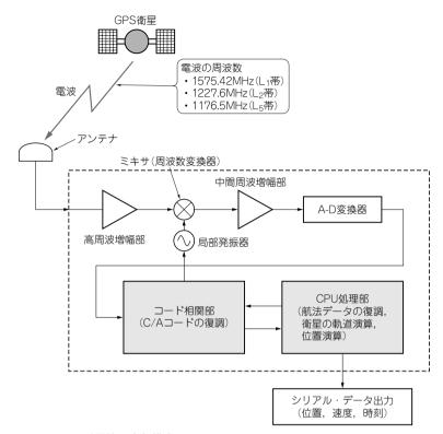
図3-1 GPS 受信機の内部構成
