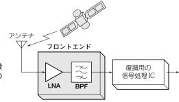
図 5-1 ワイヤレス機器のアンテナの後段 には低雑音増幅回路(LNA)やBPFなどの 高周波アナログ回路がある これをフロントエンドと呼ぶ
