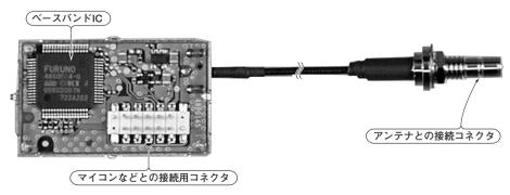
写真2-1 本章で題材にした実際のGPSモジュール(GN-80, 古野電気)
