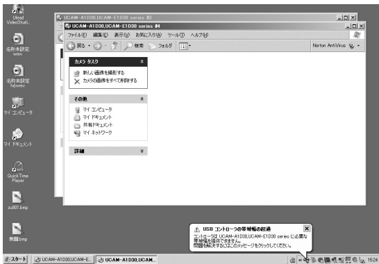
図 8-3 2 台の USB カメラの同時プレビューができない場合使用するチップやシステムによっては複数台のカメラの認識、個々のプレビューができて同時プレビューができない場合がある。
