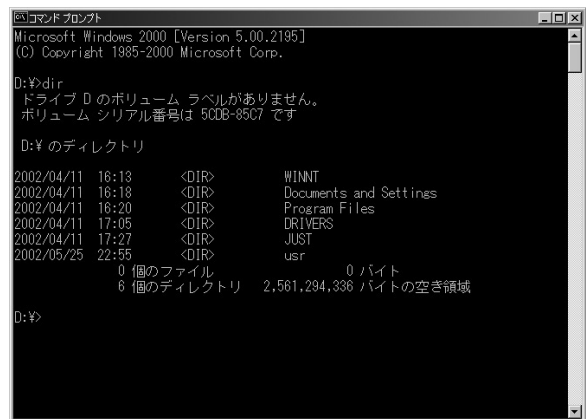
図2-2 dirコマンドを試す dirはエクスプローラの詳細表示のようなもの。
