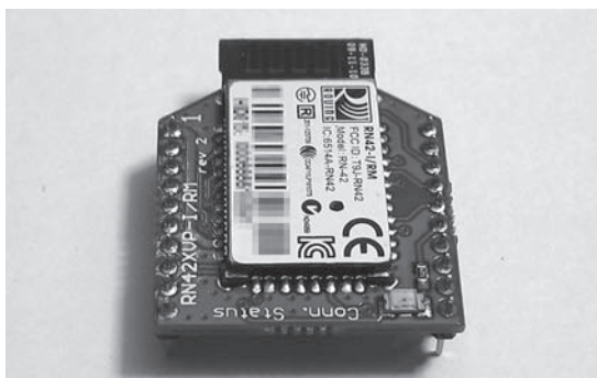
写真 11-1 Bluetooth モジュール RN-42XVP
