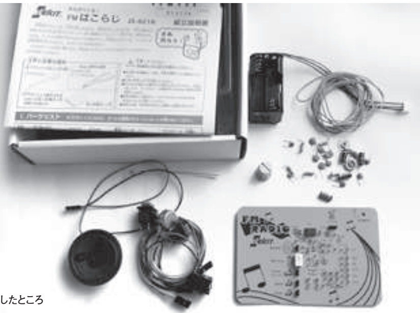
写真1-1-4 ケースとなる箱を開けると基板や部品が出てくる。収納に使われているトレイも重要な部品なので、捨てないようにしよう
