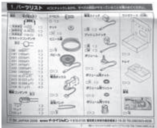
写真1-1-8 説明書のパーツ・リストはイラストで部品の形状や値の表示が詳しく示されている。不足部品がないかも確認しておこう
