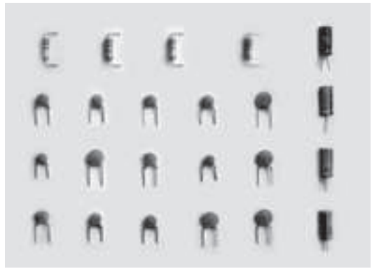
写真1-1-7 取り付ける部品はピンに合わせて加工済みなので、ラジオ・ペンチやニッパなどの工具も不要だ
