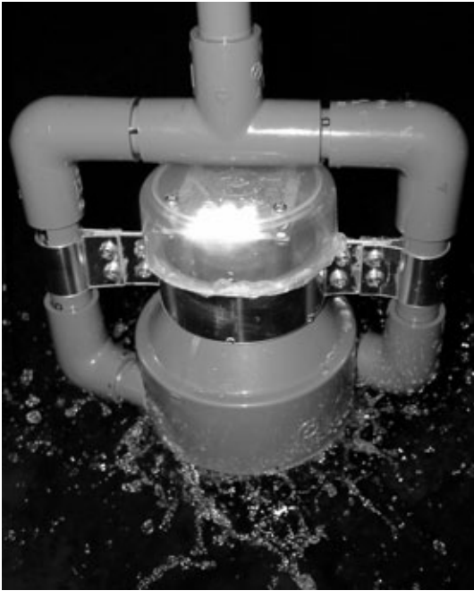
写真10-1 水道水の圧力で高輝度LEDを点灯する
