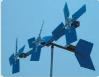
(a) 3基の風車を搭載した風力発電機
