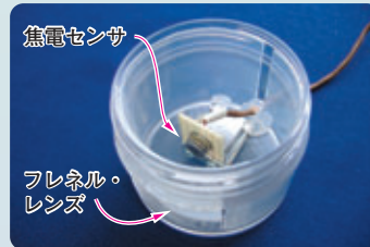
(b) フレネル・レンズで検出距離を2→5mに
