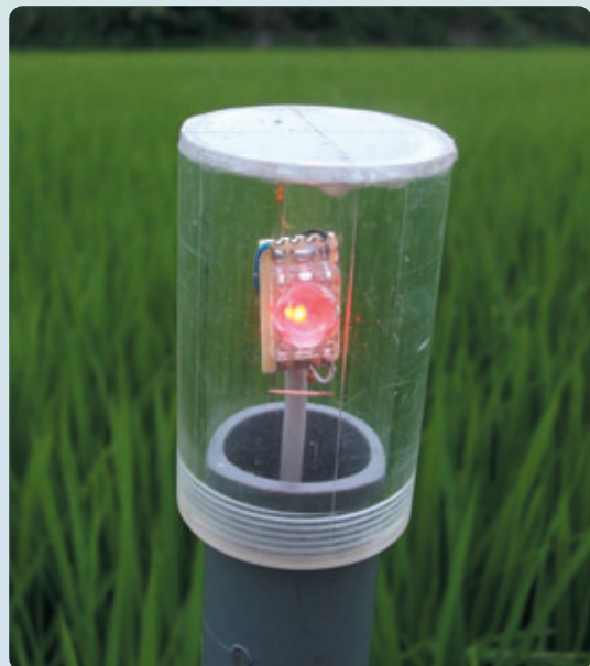
(b) LEDの点滅で水位を知らせる
