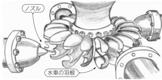
図10-1 ノズルからのジェット水流を利用するベルトン水車
