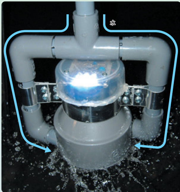
(a) 水道水の圧力で高輝度LEDを点灯
