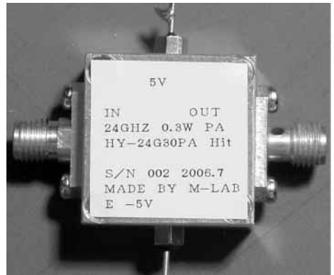
〈写真1-14〉 24 GHz 300 mWパワー・アンプ(Hittite社デバイス使用)
