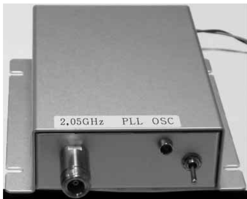
〈写真1-7〉 2GHz 0dBm PLL OSC
