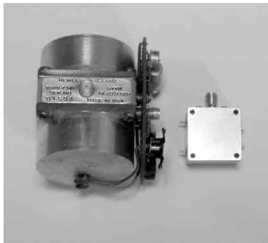
〈写真1-2〉YIG発振器の例〔左はHP社製YIG（4～8 GHz），右は超小型YIG（メーカー不明）〕
