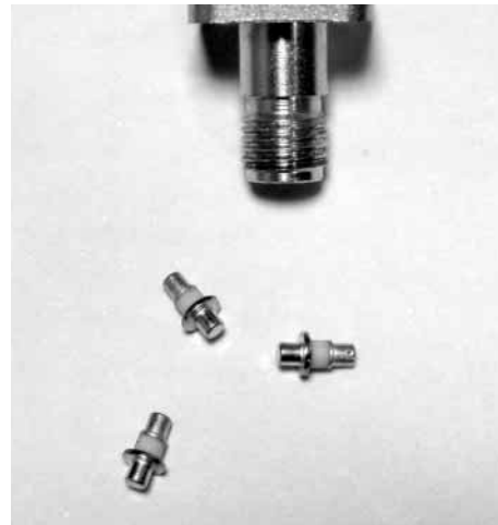
〈写真1-5〉NEC製SV-24B(形状からビル・タイプと呼ばれるステップ・リカバリ・ダイオード)
