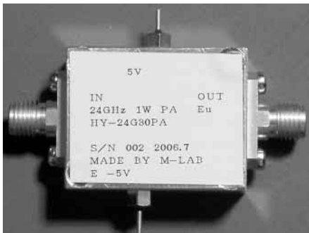
〈写真1-16〉 24 GHz 1 Wパワー・アンプ(Eudyna社デバイス使用)
