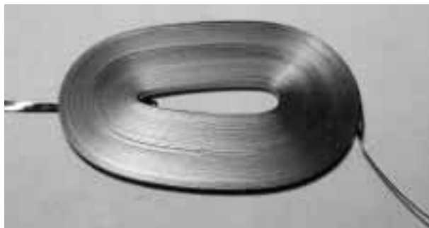
〈写真3-32〉平角線による巻き線コイル
