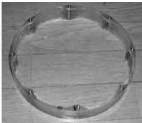
〈写真3-31〉FRPで製作した側面枠
