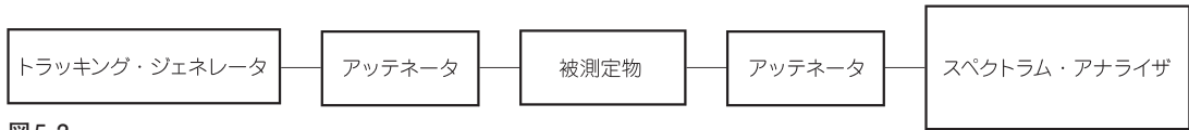
図5.2 被測定物とトラッキング・ジェネレータ、スペクトラム・アナライザをアッテネータで接続
