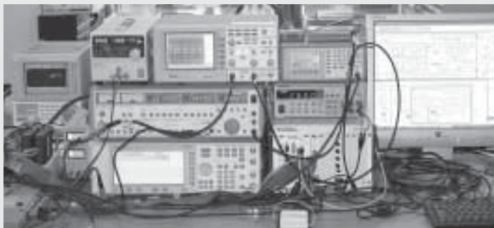
図1-1-3 研究現場の計測自動 制御システムの例
