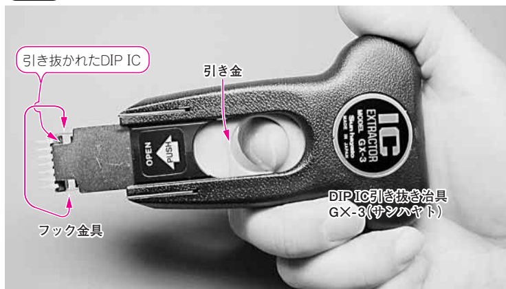
写真1 ICエクストラクタ
