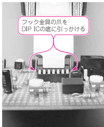
写真2 14ピンDIPを引き抜いているところ
