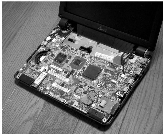
写真1-1 ノートPC ASUS製 EeePC901 の内部基板
