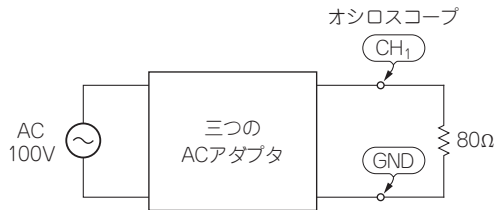
図5-2 オシロスコープで三つの電源アダプタの出力を観測する
