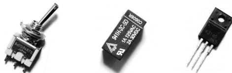
写真5-3 (a) 手動メカニカル・スイッチ (b) メカニカル・リレー (c) 半導体スイッチ MOSFET
