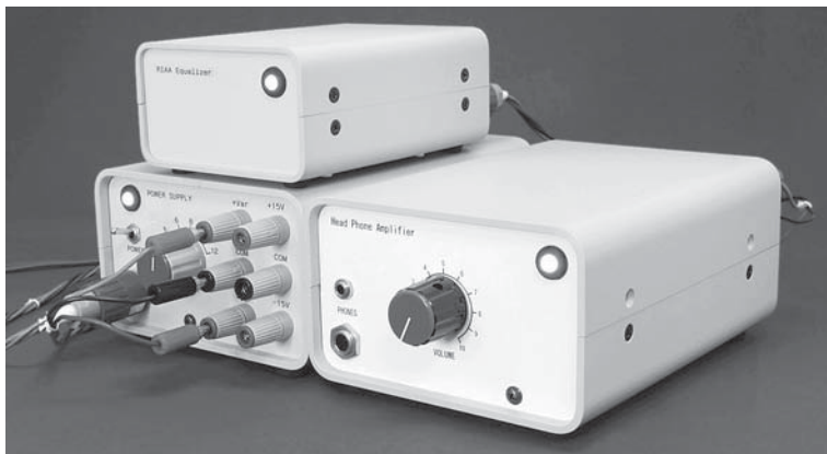
写真 5-3 製作したヘッドホン・アンプ (右下)
