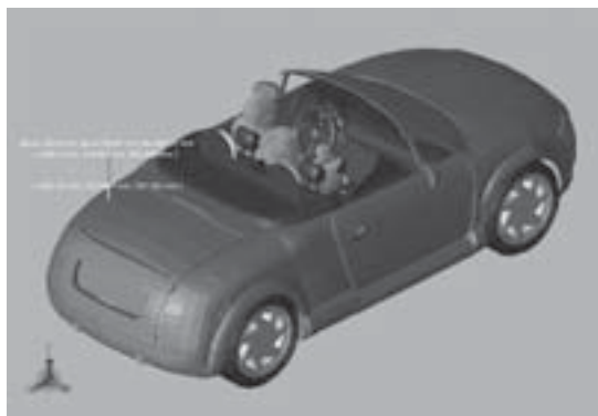
モービル・ホイップのシミュレーション・モデル (XFDTDを使用・構設計画研究所提供)
