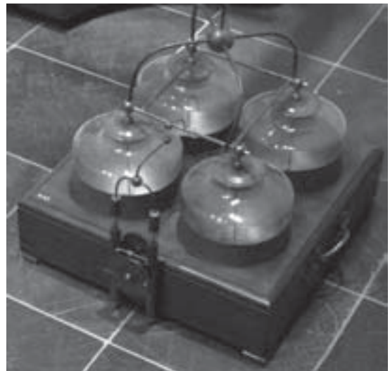
写真2-2 ライデン瓶(コンデンサ)の一例
