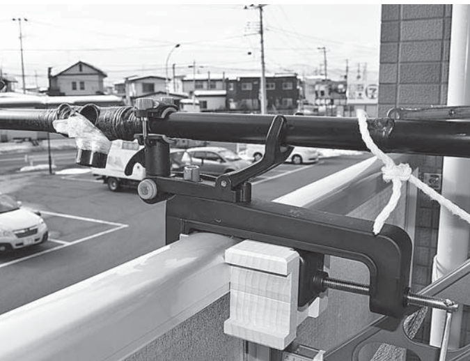
写真1-1-6 釣り竿受けにパイプを固定して基台を取り付けた
