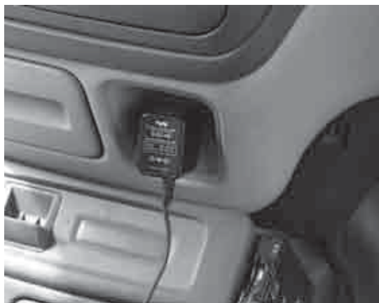
写真 4-1-1 シガー・ソケットから電源を供給
