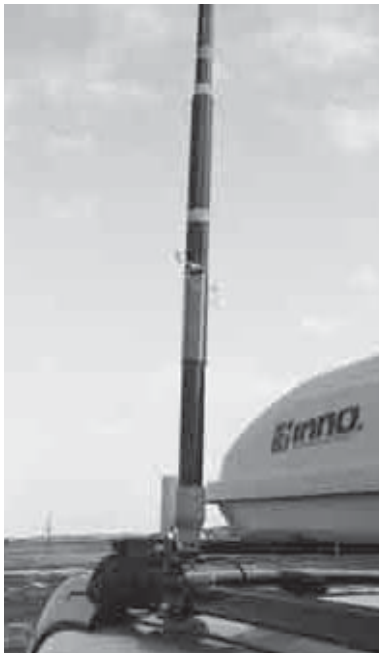
写真 2-1-2 コイルがコネクタに近い位置にあるベース・ローディング・タイプ
