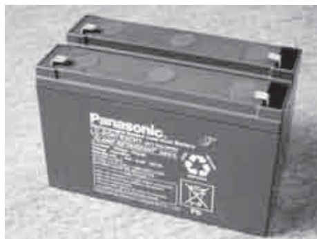
写真 3-1-1 販売していたジャンクのシール鉛蓄電池 2 個直列につないで 12V 7.2Ah
