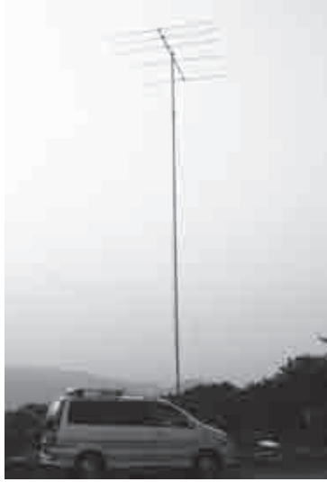
写真 5-2 高さ 12m にアンテナを設置できるいわゆる「おぼけポール」。ただしこれはエキスパート向けの装備
