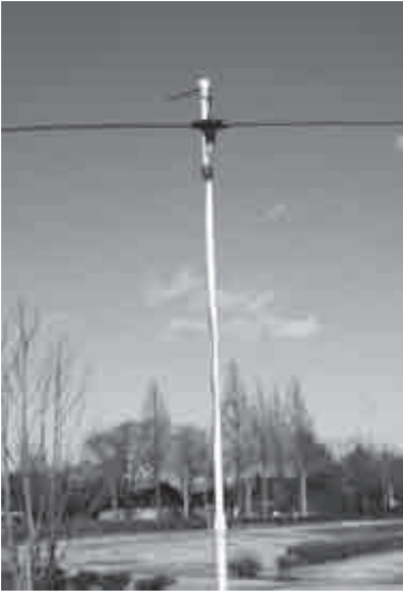
写真 5-1 のぼり用の竿を使ってもアンテナを設置できる
