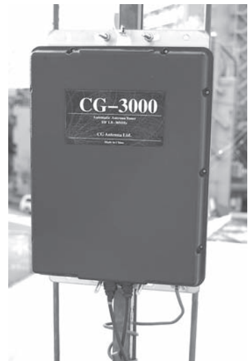
写真2-1 屋外型アンテナ・チューナ 給電点に設置するタイプのアンテナ・チューナの例(CGアンテナ CG-3000)
