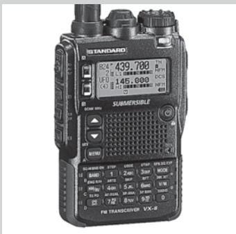
写真1-A 八重洲無線 VX-8D テンキー付きFMトランシーバの例。送信中にテンキーを押すことで、DTMFトーンが送信できる
