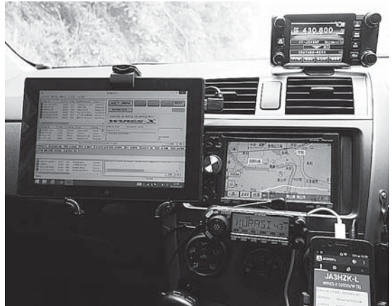
写真1-10 車内に設置したWIRES-Xノード モバイル・インターネット回線を使った車載ノードの例 (写真提供：JE1SMF 西村さん)
