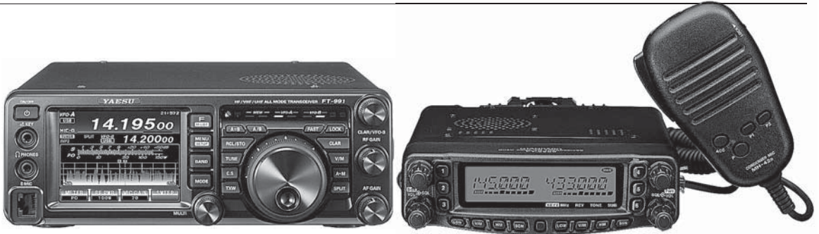
写真1-12 C4FMノード・アクセスに対応したFT-991(左), 50MHz FMノードの運用とアクセスにも対応したFT-8900(右)
