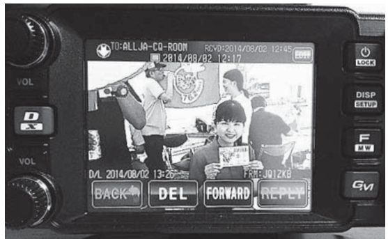
写真1-5 WIRES-Xでダウンロードした画像 ルームとノードにそれぞれ画像をポストできる掲示板のような機能があり、アップロードとダウンロードが可能
