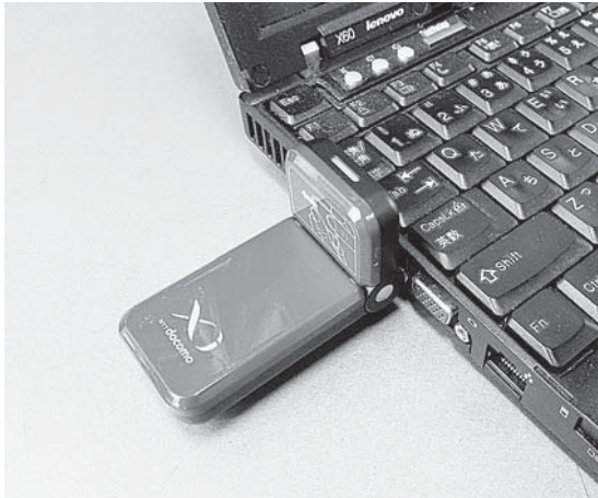
写真1-9 USBにデータ端末を挿して使うタイプのインターネット回線でWIRESも動く
