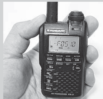
写真1-C 八重洲無線 VX-3 DTMFメモリ付きハンディ機。DTMFメモリを使うことで、WIRES-Xノード(FM運用)で交信できる
