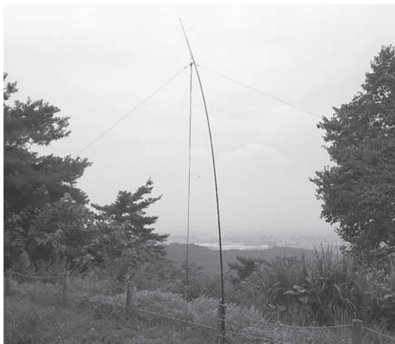
写真2-1-4 近くの小高い山の上でHFのダイポールを上げる 4mほどの釣り竿を使った、お手軽移動運用
