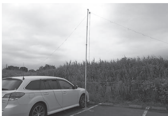
写真2-1-1 近くの公園でギボシ・ダイポールを上げる タイヤ・ベースにポールを使い、滑車で上げ下げが簡単
