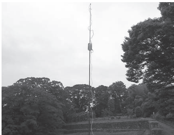
写真2-1-6 お手軽HF移動のときはVCHアンテナもお勧め 組み立て、撤収が簡単
