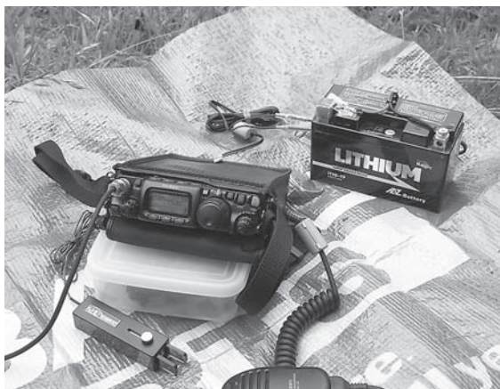
写真2-1-5 山の移動にはFT-817がベスト リチウム・イオン・バッテリーを使っている
