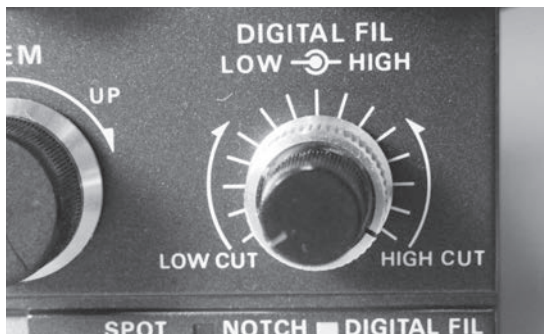
写真3-4-3 デジタル・フィルタは内軸が左、外軸が右がデフォルト位置
