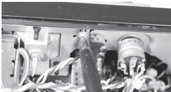
写真4-1-5 パネル中央に裏側からネジがあるので、外してから抜くこと
