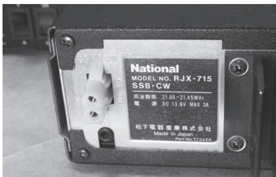
写真4-1-1 電源端子は2Pジャック。電源コード付きを入手したい
