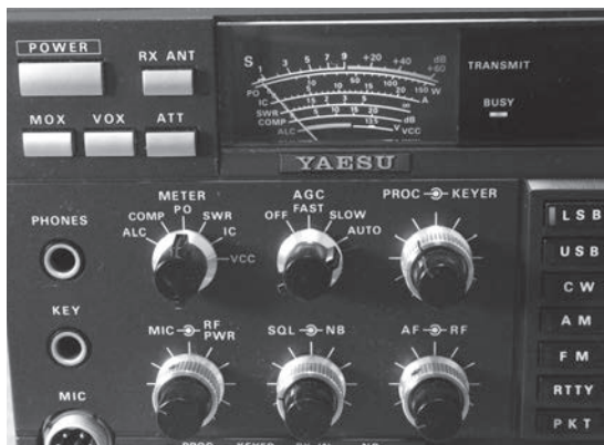
写真3-4-1 大型アナログ・メータの採用や、機能的で分かりやすいつまみ配置のフロント・パネル
