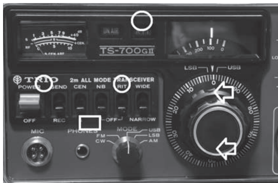
写真1-1 TS-700GIIエスカッション・プレートの止めネジ位置 丸部分の裏にネジ 四角部分に爪 矢印部ツマミの陰にネジ
