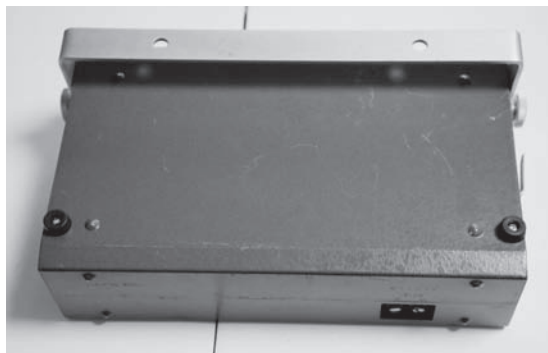
写真1-1 本体底部のゴム足にネジがある
