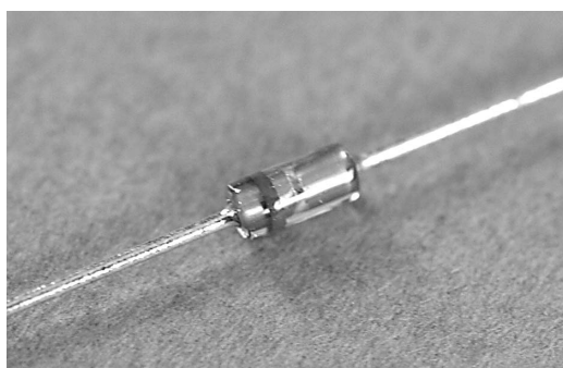
写真6-1 スイッチによく使われる汎用ダイオード(1S1588)
