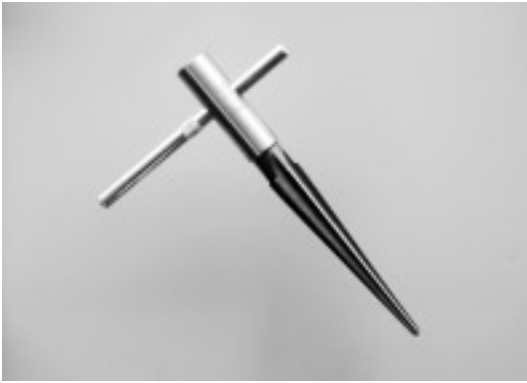
写真1-8 テーパー・リーマで穴を大きくする
