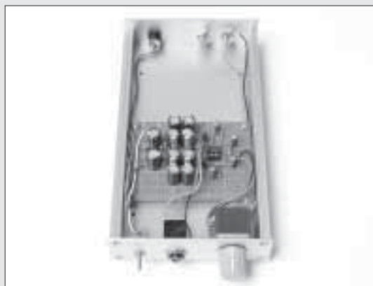
写真2-1 OPアンプを使ったヘッドホン・アンプ
