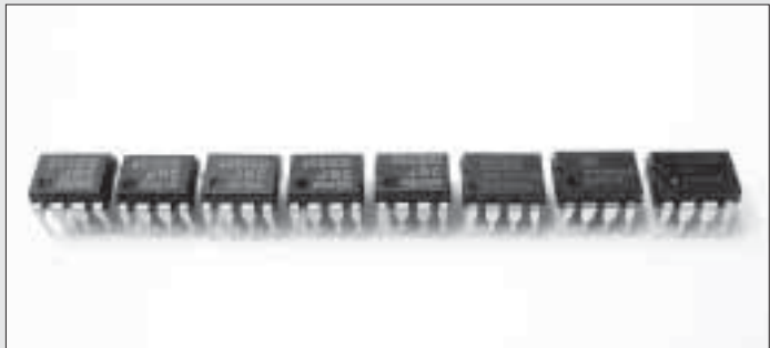
写真2-3 左からNJM2114A, NJM4558, NJM4556A, NJM4580, NJM5532, OPA2134, OPA2604, LME49860 いずれも比較的容易に入手できるポピュラなOPアンプ。
